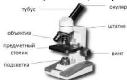
Рис. 2. Строение микроскопа
