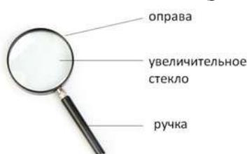
Рис. 1. Строение ручной лупы
